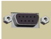
d) Kommunikation (Buchse D-Sub 9-polig)
